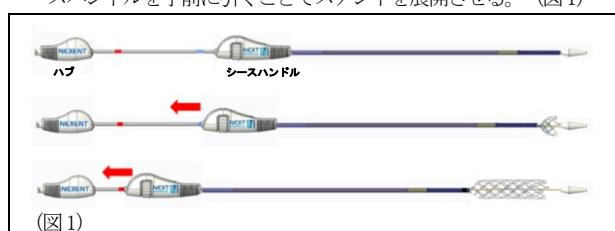
⑤ステントが完全に展開し、正しく留置されたら、片手でハブを固定し、もう片方の手でシースハンドルを前方に押してデリバリーシステムを閉じ、その後、デリバリーシステム及びガイドワイヤーを抜去する。抜去中に過度の抵抗が感じられる場合は、さらにステントを拡張できるよう3~5分待つ。
